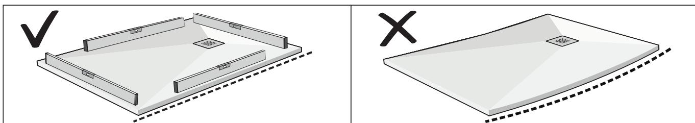
Durante l'ispezione del prodotto, verificare che sia completamente piano. Controllare anche le pendenze di drenaggio e che non vi siano elementi danneggiati. Se si devono effettuare tagli sul prodotto, utilizzare una sega radiale con disco diamantato per non alterarne la stabilità strutturale.
