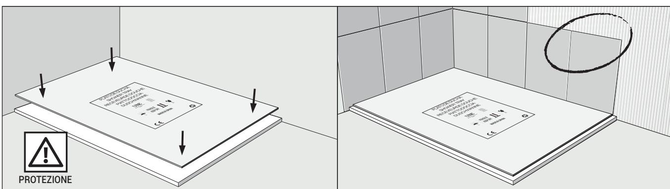
**Lasciare asciugare per 24 ore prima del primo utilizzo o dell'installazione di elementi fissi come cabine doccia o piastrelle.**
